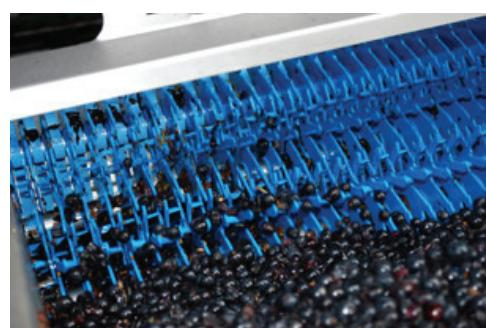
● Séparateurs à rouleaux rotatifs : la machine est constituée d'égrenieurs linéaires vibrants, à haute fréquence, alimentant une table de tri à rouleaux. Cette dernière comprend des rouleaux pleins crantés de transfert et des rouleaux creux séparant les baies des rafles, pétiolaires et corps étrangers.
