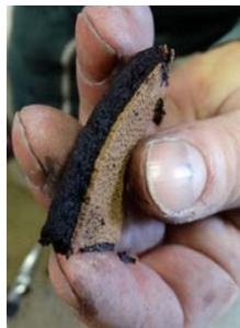
Photo 1. Gâteau de filtration avec les fibres végétales sélectives en précouche
